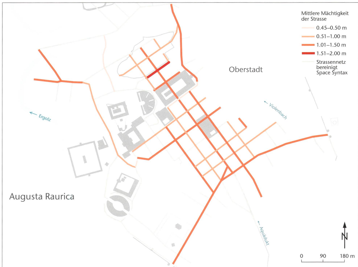
Abb. 18: Augusta Raurica. Strassennetz mit Darstellung der unterschiedlichen Klassen von Mächtigkeiten der Strassenaufkofferungen. Grundlage bilden die durch Karl Stehlin und Rudolf Laur-Belart dokumentierten Strassenschnitte. M. 1:9000.
