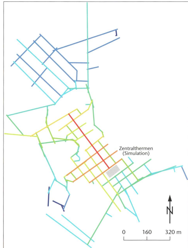
Abb. 10: Strassenetzwerk von Augusta Raurica. Simulation mit Ost-West orientierten Zentralthermen. Axial Analysis, Integration (HH, n-streets = 99), UCL Depthmap Version 10.14.00b. M. 1:16 000.
