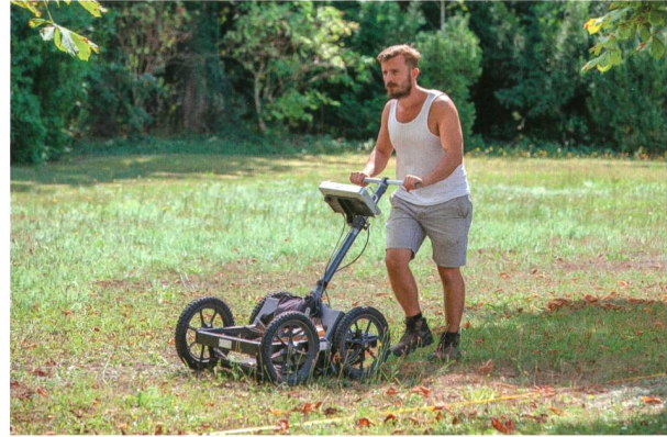
Abb. 6: Michal Vágner (Universität Brno) beim Abschreiten der Messfläche auf Kastelen mit dem Bodenradarmessgerät.
