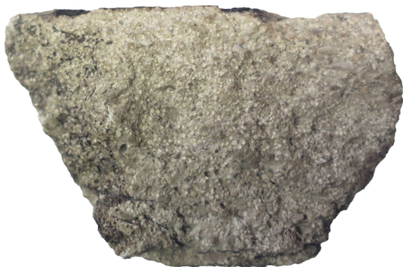
Abb. 10: Augusta Raurica. Hauptrogenstein (Dogger) mit typischer körniger Ausprägung, mit der Inschrift 101. Breite des Steins ca. 8 cm.
