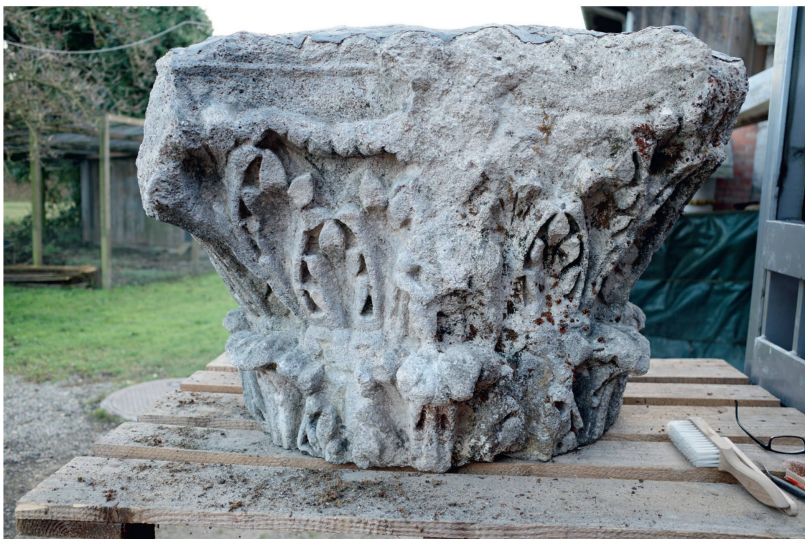
Abb. 40: Augst BL, Grosssteinlager Schwarzacker (Monumentenrestaurierung ohne Nr.). Korinthisches Kapitell aus Rauracien-Kalkstein während der Reinigung. Die rechte Hälfte ist bereits vollständig gereinigt, die linke weist noch die typische schwarze Biopatina und Reste von Moosbewuchs auf. Durch die Reinigung kommt auch die bildhauerische und künstlerische Qualität vieler Stücke wieder besser zur Geltung (ohne Inv.).
