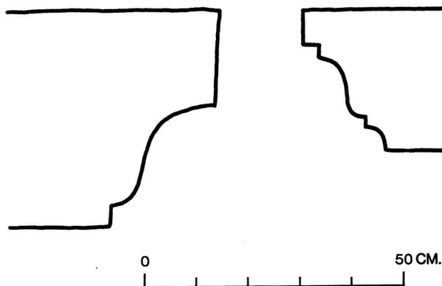
Fig. 5. Relevé des moulures des blocs réemployés dans le mur d'enceinte du Bas-Empire et laissés en place. - 1:10.
