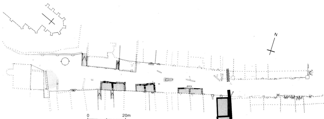
Abb. 33. Burgdorf BE, Kirchbühl. Archäologische Aufschlüsse. Stand Ende 1991. Zähringische Stadtmauer und Häuser (schwarz und dunkler Raster) sowie festgestellte Innenräume (mittlerer Raster). Im Westen die Pflasterung des mittelalterlichen Beginengässchens (heller Raster). M 1:1000. Zeichnung ADB (M. Leibundgut).
