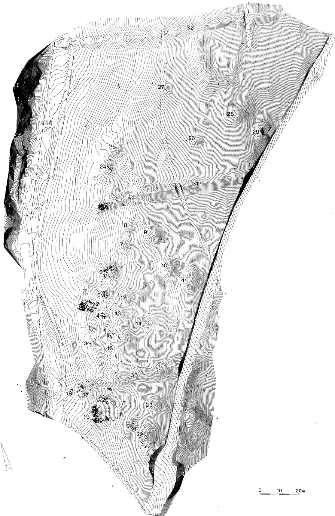
Abb. 1. Stälzler, Lampenberg BL. Topographischer Plan des Fundgeländes. 1–29 Hügel; 30–32 Wälle; kleine Kreuze: Oberflächenfunde 1991. Äquidistanz der Höhenlinien: 0.10 m. Topogr. Aufnahme: W. Huber; Automat. Kartierung: Geocad AG, Liestal.
