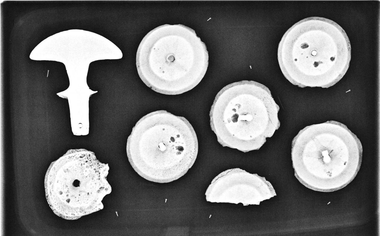
Abb. 27. Kaisten AG, Bronzekomplex. Röntgenbild der verzierten Objekte (Steckaufsatz [links oben] und Nagelscheiben) 0.260\text{dGy}\cdot\text{cm}^2 . Die Porosität der Nagelscheiben ist ein Hinweis auf ihre Herstellung durch Guss. Röntgenbild CIM SA, La Chaux-de-Fonds.
