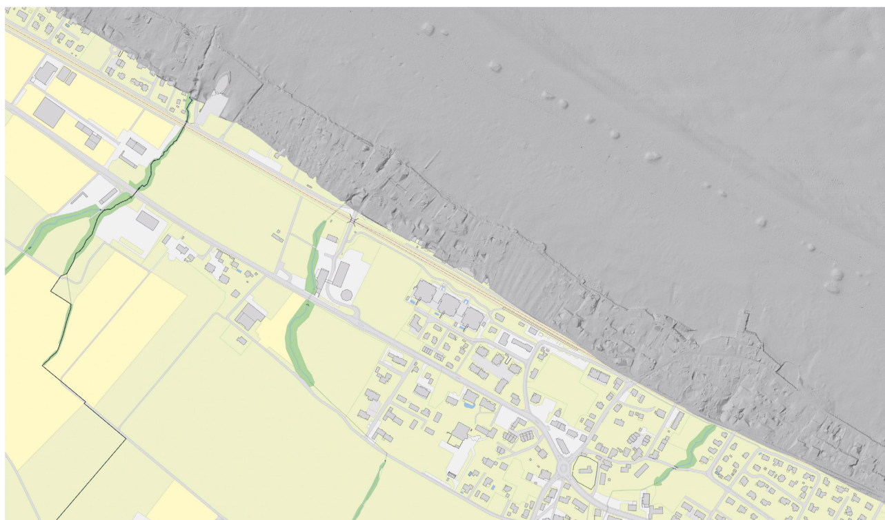
Abb. 2. Uttwil TG. Die Anomalien auf dem hochaufgelösten Tiefenmodell - basierend auf Daten vom Fächerecholot und topobathymetrischem Laser (Wessels et al. 2016) - sind in der Flachwasserzone gut erkennbar. Plan AATG, Matthias Schnyder und LUBW, Martin Wessels. Reproduziert mit Bewilligung von swisstopo.
