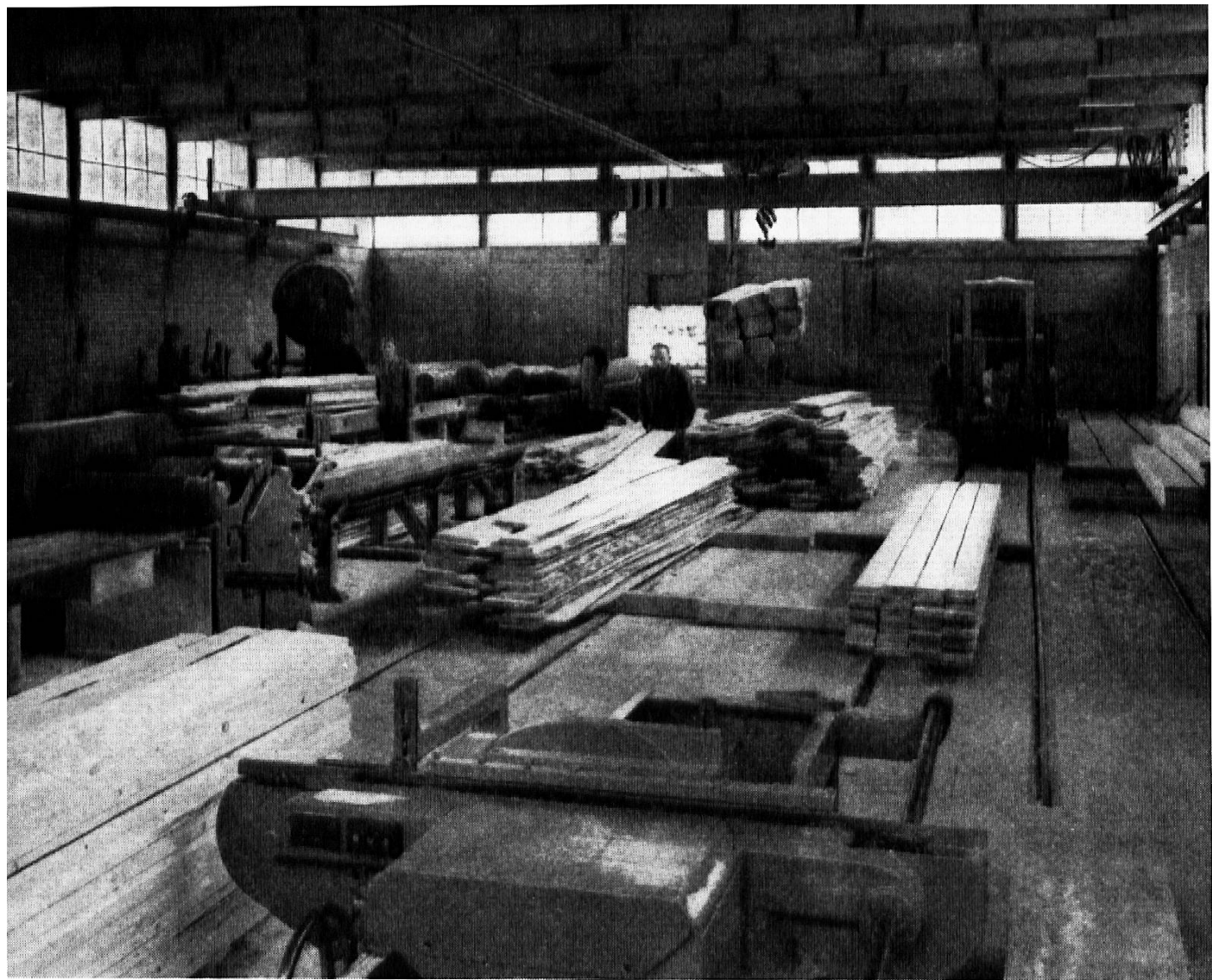
Neuzeitliche Sägerei in Graubünden mit Blockbandsäge und Vollgatter
