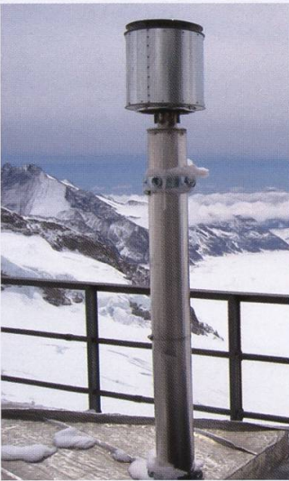
Abbildung 2: Das Einlass-System für die Aerosolmessungen. Es ist so konzipiert, dass auch die in Wolkentropfchen enthaltenen Aerosolpartikel mit erfasst werden.
