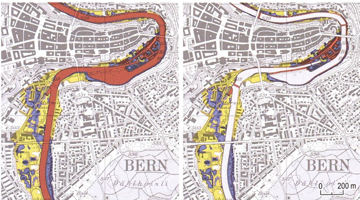
Abb. 12: Gefahrenkarte für den Bereich Marzili/Matte in der Stadt Bern; links: Original, rechts: Variante
