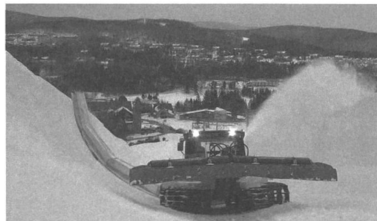
Abbildung 15: Pipe-Monster beim Präparieren einer Halfpipe-Piste. (Bild: Zaugg AG)
