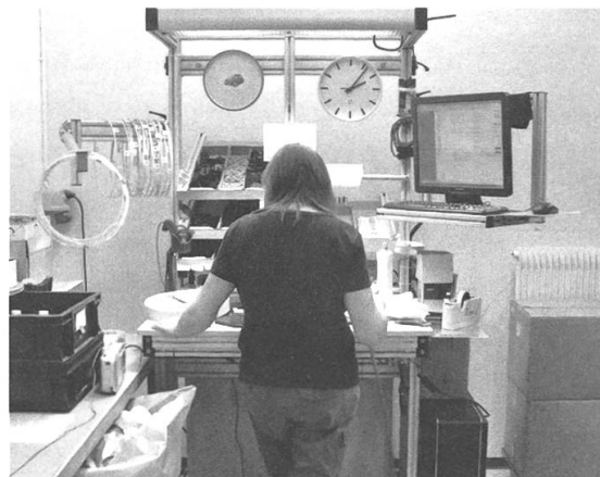
Abbildung 9: Montageplatz für Bahnhofsuhren. (Bild: Hans Wiedemar)
