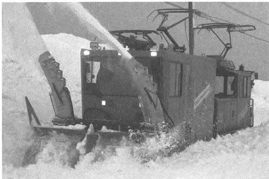
Abbildung 14: Schneeräumen mit Schneefrässchleuder, Wengernalpbahn. (Bild: Zaugg AG)
