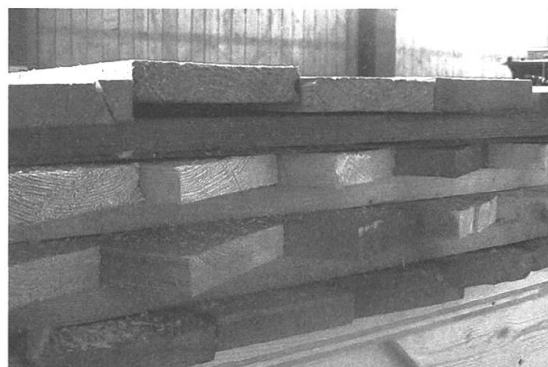
Abbildung 11: Kreuzweise geschichtete Bretterlagen für eine zukünftige Hauswand. (Bild: Truber Holz)
