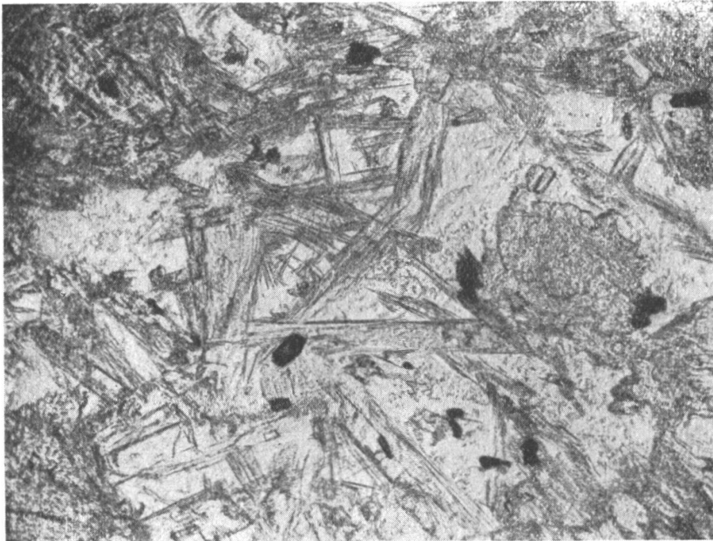
Fig. 1. Innig miteinander verwachsene, feinfasrige Mineralien eines Eklogit-Steinbeils. Burgäschisee Ost. Dünnschliffphoto, Vergrößerung 65-fach.
