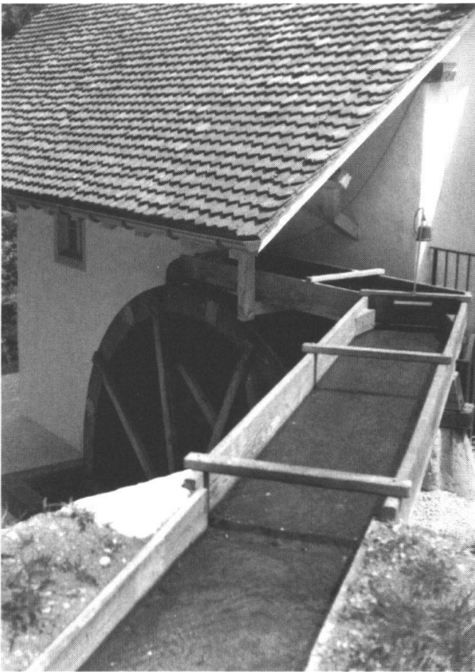
Abb. 6: Oberschlächtiges Wasserrad mit Zulaufkanal.
