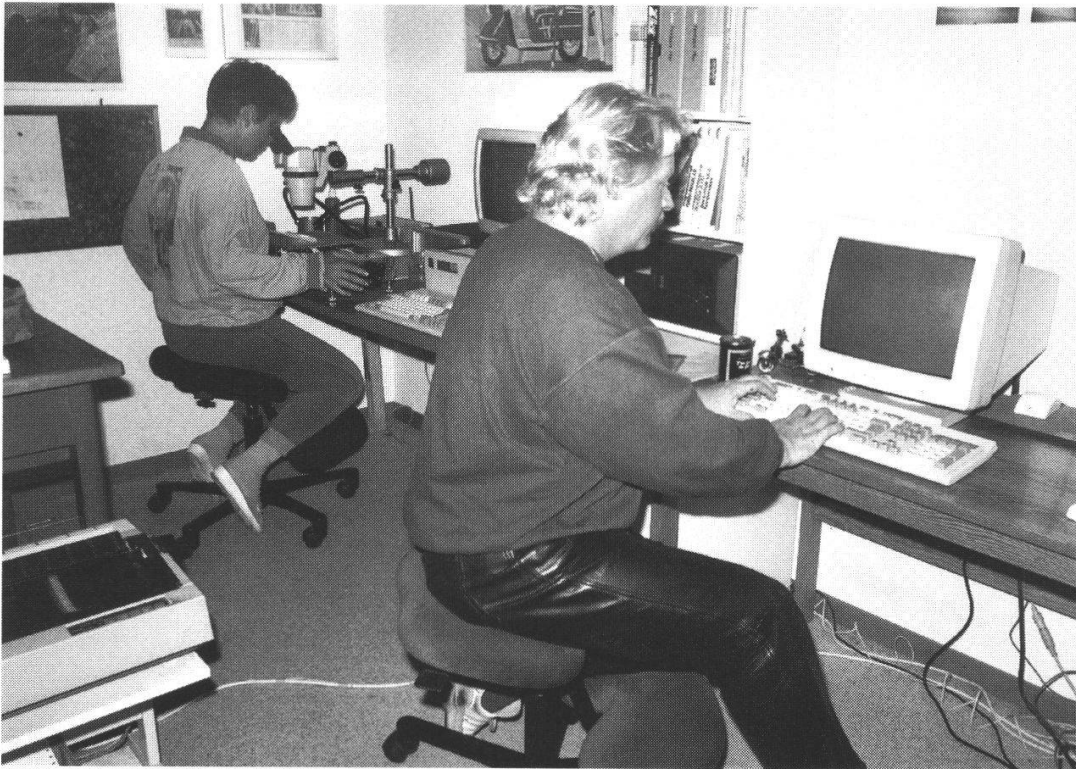
Abb. 1: Ein Blick ins Dendrolabor. Links wird am Mikroskop eine Holzprobe optisch gemessen, rechts werden die Daten mit Hilfe eines Computers ausgewertet, auf ihre Gleichläufigkeit mit Standardkurven überprüft und die Datierung ermittelt.
