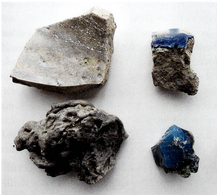
Abbildung 13: Fragmente von Glashäfen (oben), Schlacke (unten links) und ein Stück blaue Glasmasse (unten rechts) – Schafmatt I, untere Hütte.
