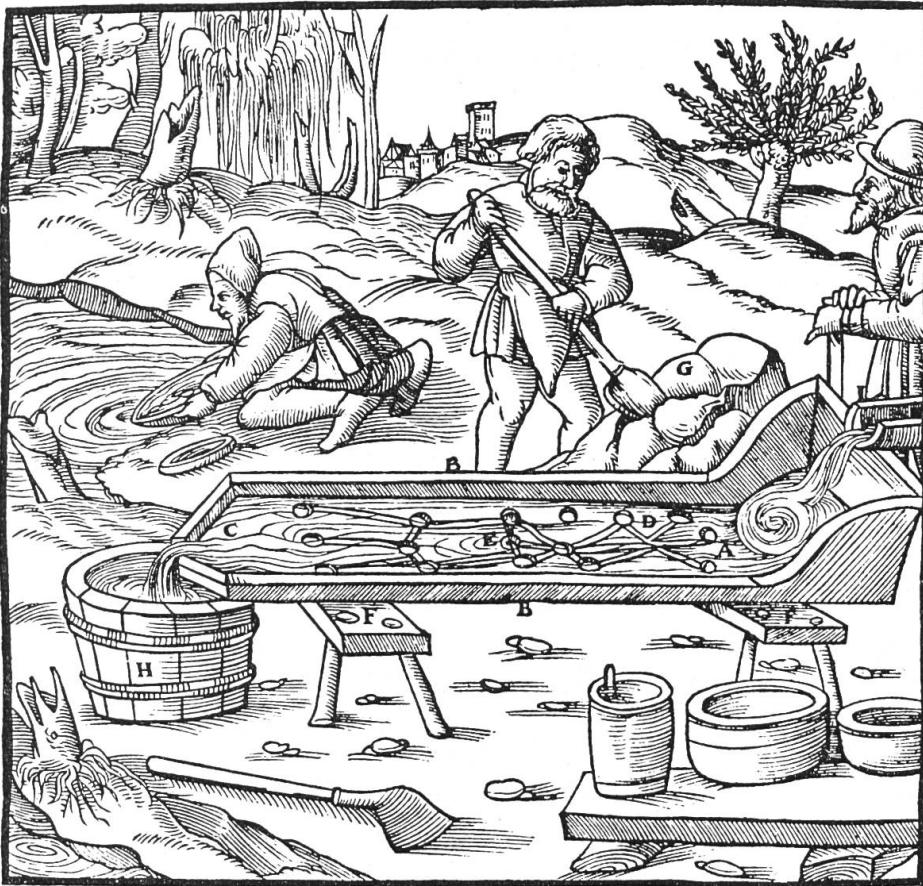
Der Goldstuhl, außerhalb des Flusses, braucht eine Wasserzuleitung (rechts im Bilde). In den Grübchen und Rillen sammelt sich der Goldschlich. Der wertlose leichte Sand fließt mit dem Wasser in den Bottich links.
