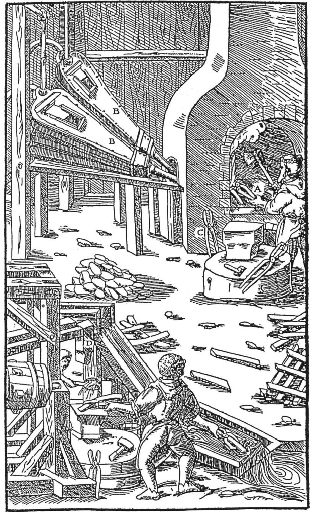
4 Blick in eine Schmiede mit Schwanzhammer (links) und einem Schmiedefeuher. Aus dem Bergwerksbuch von G. Agricola.
