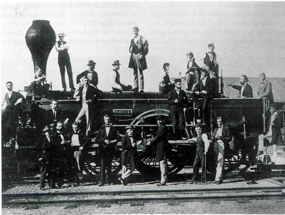
1 Schnellzug-Schleppender-Lokomotive, Bauart 2B, Nr. 15 «BRUGG» der Schweizerischen Nordostbahngesellschaft NOB, hergestellt von «J. A. Maffei» in München 1856, Aufnahme mit Studenten des Polytechnikums unter der Leitung von Prof. Releux, vermutlich kurz nach der Ablieferung der Lokomotive im Juni 1856, Fotograf(in) unbekannt. – Typisch für die ersten Lokomotiven in der Schweiz waren der Funkenfänger im Kamin wegen der Holzfeuerung und der völlig ungeschützte Arbeitsplatz des Personals.
