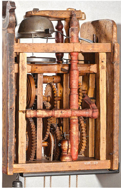
Bündner Holzräderuhr. Graubünden, 1760. Gehwerk mit Radunruhe, 4-Viertel- und Stundenschlagwerk, Wochentage, Monate, Mondphasen und Mondalterangabe. Inv. 129. Komplikationen wie Viertelstundenschlag oder Mondanzeige wie auf dieser Davoser Uhr waren nicht üblich. Sie ist das bis heute einzige bekannte Exemplar aus dem Sertigtal mit kalendarischen und astronomischen Anzeigen. Oben sind drei Hilfszifferblätter zu sehen, rechts für die Wochentage, oben für die Monate, links für die Mondphasen und das Mondalter. Die Uhr ist vermutlich nicht von den Ambühls hergestellt worden, aber sicher im Bündnerland entstanden. Fotos Michael Peuckert
