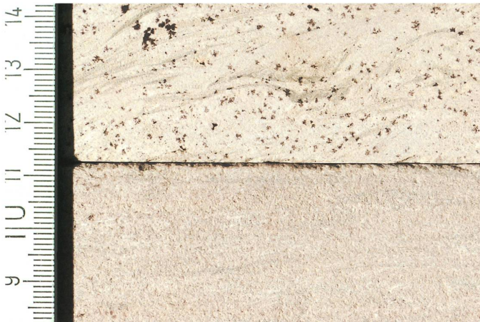
Abb. 8 Flasersandstein vom Steinbruch Am Eichberg bei Degerfelden (oben) und Flasersandstein aus der originalen Bausubstanz am Basler Münster (unten). Die Fleckung durch Manganoxide ist auch am Münster bisweilen anzutreffen, jedoch nicht ganz so ausgeprägt wie im dargestellten Probestück vom Eichberg. Die übrigen Merkmale stimmen überein: Korngrösse, -zusammensetzung, -verteilung und -bindung sowie die typische Einschaltung grünlicher Tonfasern mit unruhiger, gefaseter Textur. Foto Wolfgang Werner, 2019
