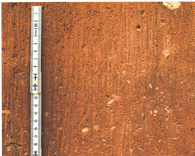
Abb.2b Daneben findet sich ein kräftig roter, feinkörniger Plattensandstein («Wiesentaler»), der vor allem für Skulpturen, Fenster- und Türgewände, Masswerke und Zierelemente verwendet wurde, sich für Sockelquader hingegen wegen seines Tongehalts weit weniger eignete. Nach dem Basler Erdbeben vom 1356, als in der ganzen Stadt dringend Baumaterial benötigt wurde, setzte man ihn vermehrt auch im Aufgehenden als Quader ein. Foto Bianca Burkhardt, 2019
