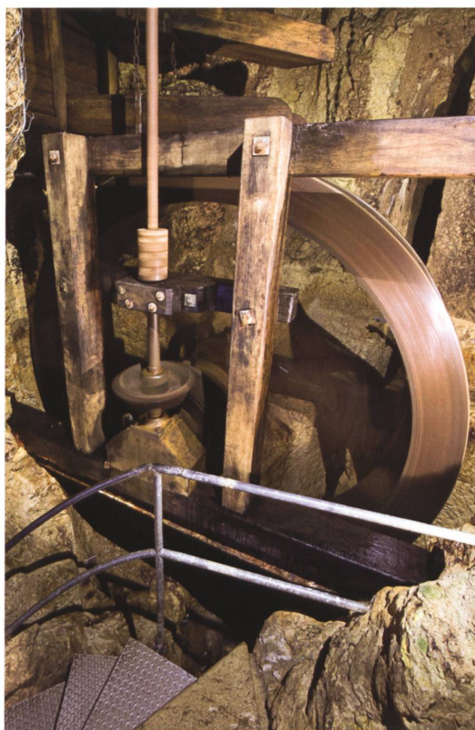
La roue hydraulique du deuxième puits. Par le biais d'un axe vertical et des engrenages, elle actionne le moulin à céréales. Photo Michael Peuckert, 2023
