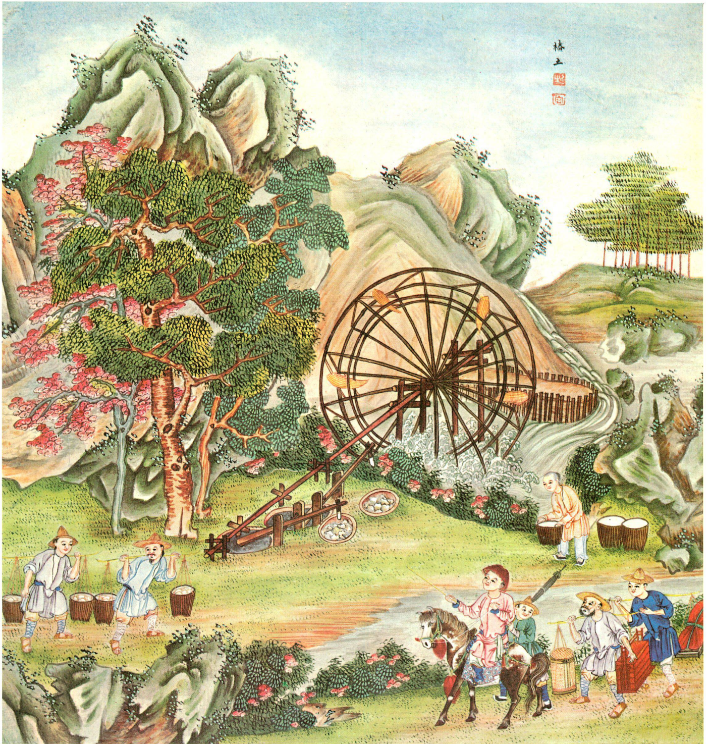
Stampfwerk zum Zerschlagen des Kaolins in China um 1740. Aus W. A. Staehelin, «Das Buch vom Porzellan», Bern 1965.
