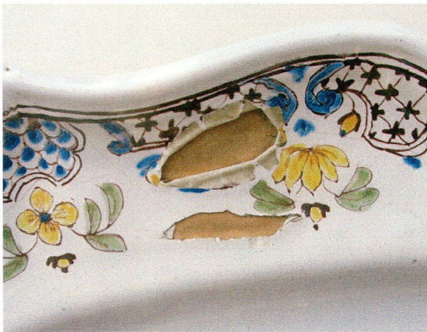
Abb. 8. Detailaufnahme der ovalen Platte Abb.7, vom Scherben abgelöste Glasurstellen.
