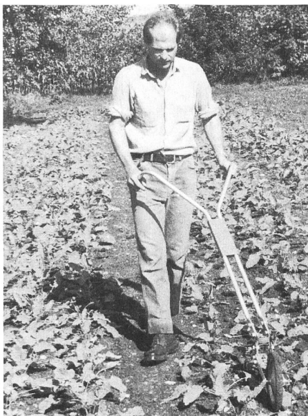
Die REAL-Radhacken sind leicht und handlich – ideal für Jätarbeiten in Gemüsekulturen. Sie können mit verschiedenen Werkzeugen ausgerüstet werden (12,5–70 cm). Die scharfen Pendelmesser erlauben den Einsatz schon, wenn die Kultur noch ganz klein ist.
