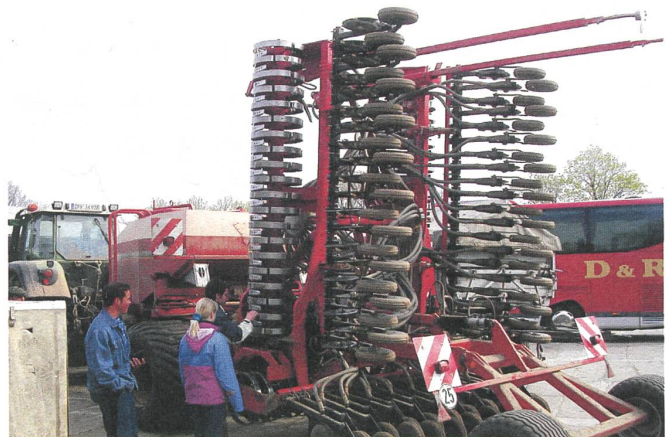
Sämaschine im EU-Format mit neun Meter Arbeitsbreite.
