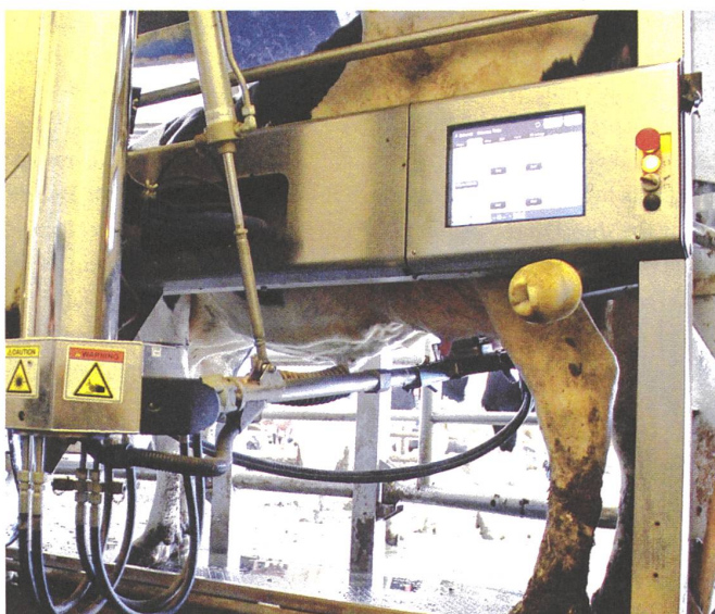
Der Twenty-four-seven-Melker bedient bestimmt auch Biokühe; misst die Milch nach Menge, Temperatur, Fett- und Proteingehalt aus jeder Zitze; spürt allfällige Krankheitserreger auf und registriert das Gewicht der Kuh...
