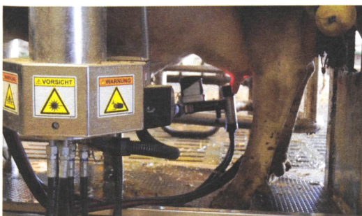
Selbstlenkender Melkarm, automatische Reinigung. – Anita Gstöhl.
