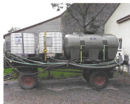
Zwei gebrauchte 1m 3 -Behälter und ein neuer 3m 3 -Behälter sind auf dem Anhänger gut befestigt und bieten mehrere Wasserentnahmemöglichkeiten.
