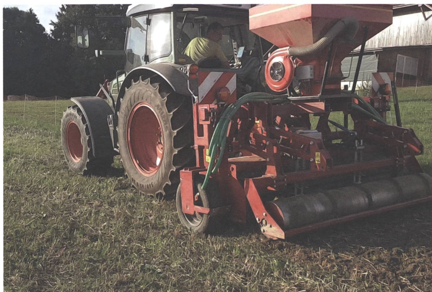
Flaches Einarbeiten der Untersaat nach der Getreideernte mit dem Geohobel.
