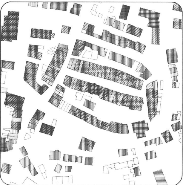
Abb. 75, Ueberlagerung Gebäudehöhe, -breite, -tiefe
