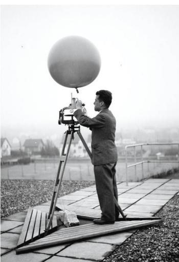
Mit diesem Ballon wurden in den 30er- und 40er-Jahren Höhenwinde gemessen.
