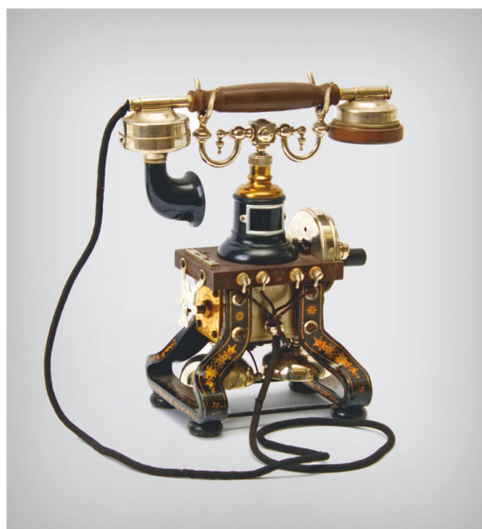
Dieses Tischtelefon von Ericsson stammt aus dem Jahr 1892 und wurde mit Wechselstrom betrieben.
