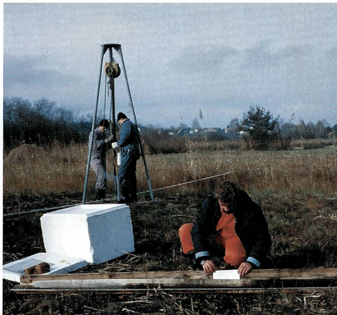
Abb. 3. Auf den Spuren Jakob Messikommers. Moderne Trockeneisssondagen im Siedlungsareal von Wetzikon-Robenhausen zur Ermittlung der Kulturschichtausdehnung im Riedgelände. Während im Hintergrund schon das Dreibein über der nächsten Bohrstange aufgestellt wird, kann die letzte gezogene Probe dokumentiert werden. (Foto Thomas Oertle, BAZ / Unterwasserarchäologie)
