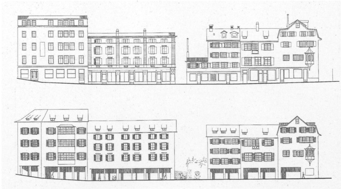
Abb. 77: Max Lüthi, Peter Germann, Ernst Rüeegger, Sanierungsprojekt für die Altstadt, Block 15 (1948). Fassaden an der Oberdorfstrasse, Bestand (oben) und Projekt, mit vorgesehenen Lauben (unten).
