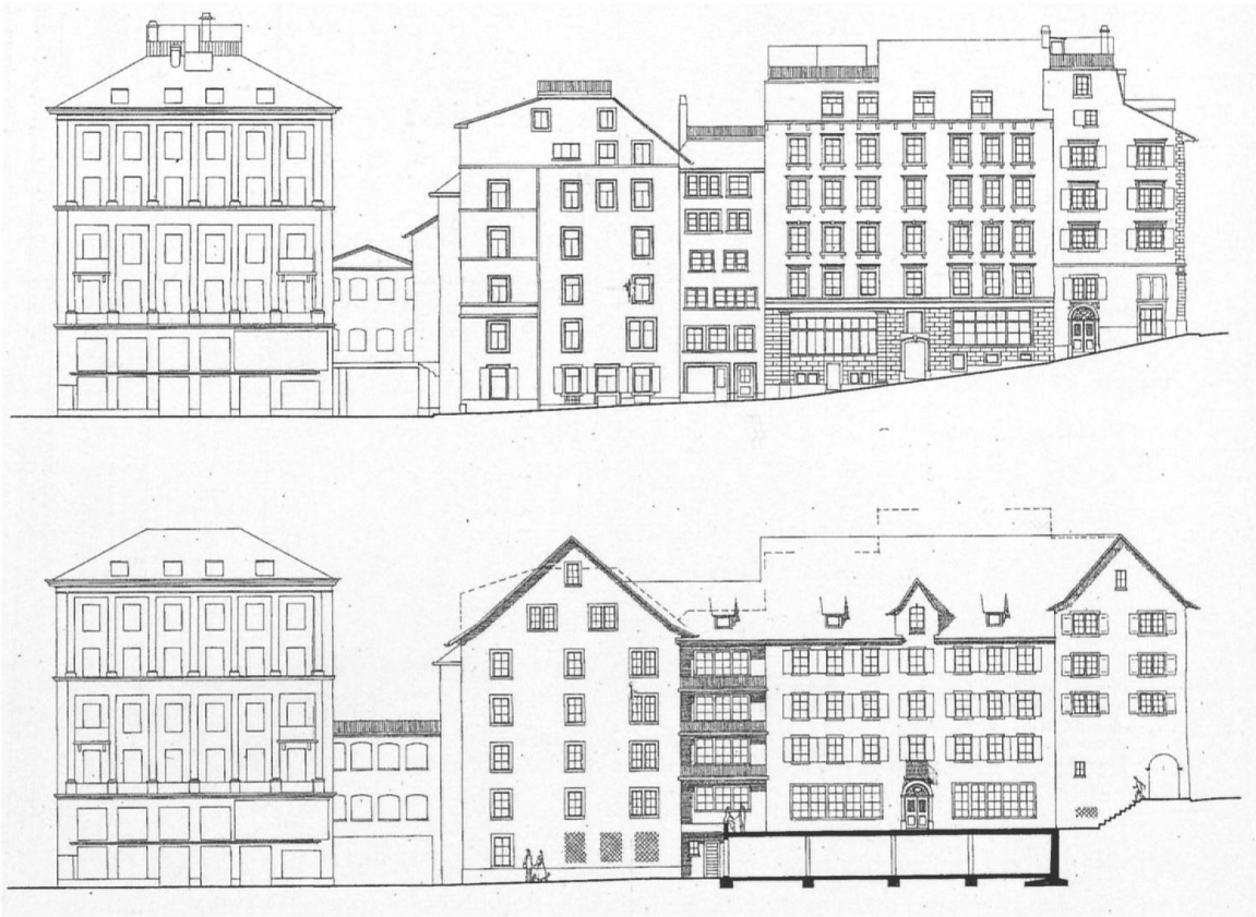
Abb. 86: Viktor Nussbaumer, Theodor E. Laubi, Sanierungsprojekt für die Altstadt, Block 19 (1948). Fassaden Geigergasse, Bestand (oben) und Projekt (unten).
