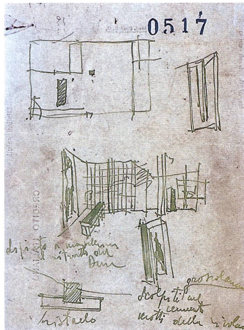
Giuseppe Terragni, Casa del Fascio, Côme, 1932-1936. Dessin d'étude pour le pilier en béton brut de décoffrage avec l'annotation: «scolpiti grossolanamente nel cemento motti della rivoluzione» («sculptés de manière rudimentaire dans le ciment les mots de la révolution»). Le Corbusier et Pierre Jeanneret, immeuble de rapport, rue Nungesser-et-Coli, Paris, 1931-1933.
