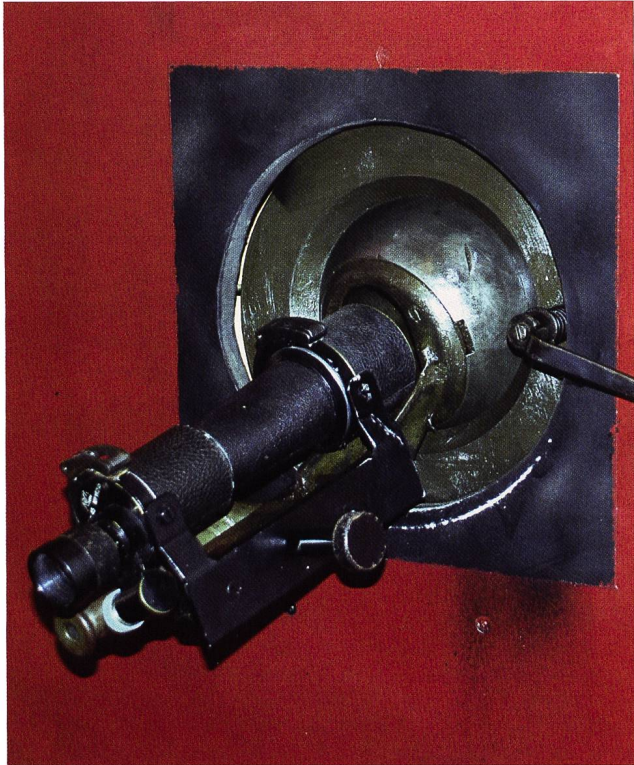
Abb. 10 Monokular zur Artilleriebeobachtung in Kugellafette, wie es in der Panzerkuppel eingebaut ist.
