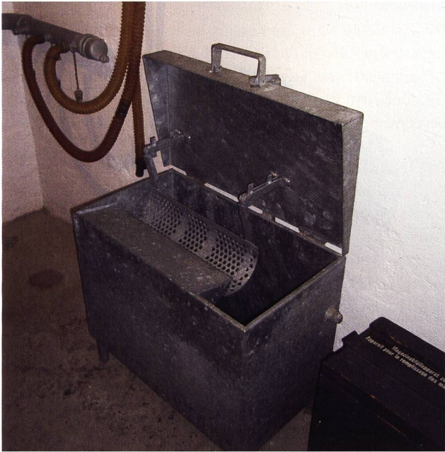
Abb. 57 Kasten zur Kühlung der heissen MG-Läufe
