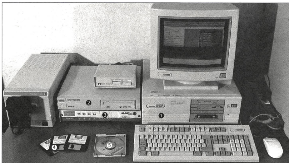
Das System am FI: Der schnelle Rechner ① (COMPAQ, Deskpro 486/25M mit 4MB RAM und 120 MB Harddisk), das CD-ROM Lesegerät ②, sowie den Multiplexer ③ für die Verbindung mit SWISSBASE. Das eingebaute Modem für die Abfrage auf DATA-STAR ist nicht sichtbar. Vor diesen Geräten liegend sehen wir folgende Datenträger: Disketten des CCOD ④ und die CD-ROM von Spolit ⑤.
