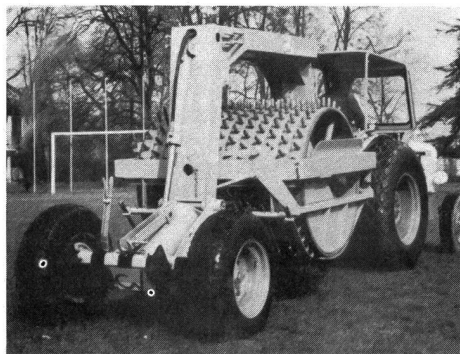
Aérateur à moteur
