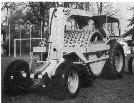
Aérateur à moteur
