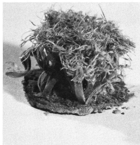
Fibres transformées par l'usure (fendues et formant, ainsi, une multitude de fibrilles très fines).
