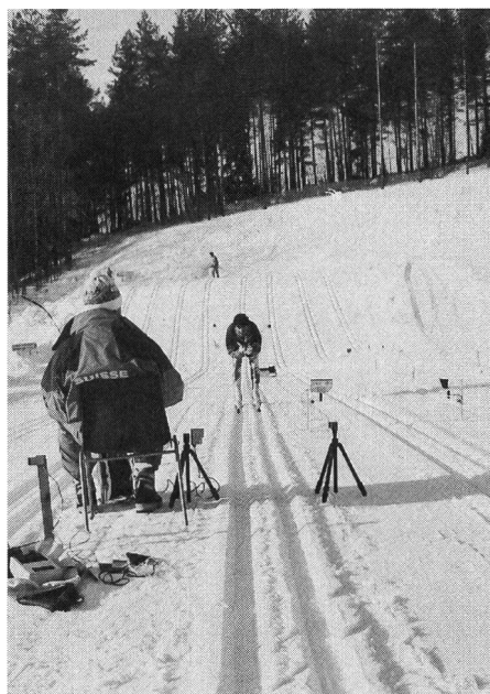
Test de glisse: trace, testeur, cellules électriques et rédacteur du procès-verbal.
