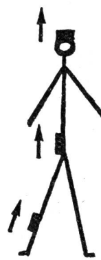
Schema delle posizioni e delle direzioni di misurazione dei trasmettitori d'accelerazione.
