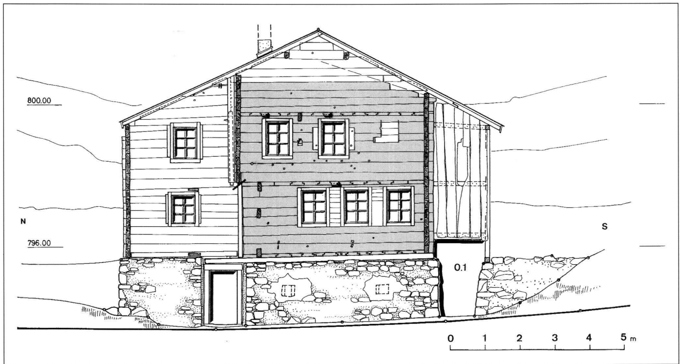
Abb. 16: Aufriss der Westfassade. Zum ursprünglichen Bestand gehörige Bauteile sind gerastert (nach Weber und Nägeli).
