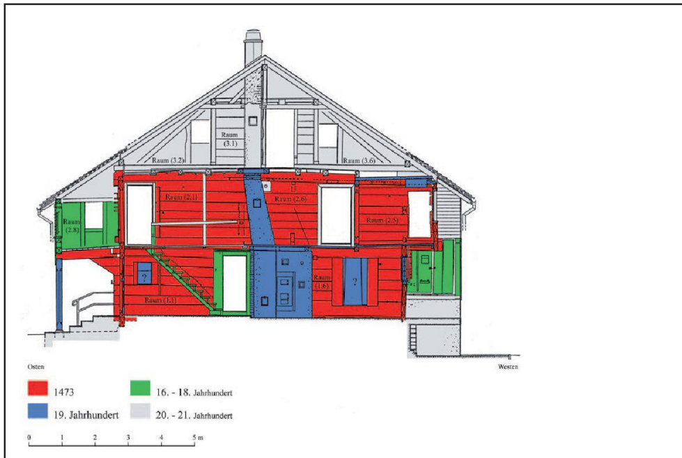
Abb. 14: Querschnitt gegen Süden.
