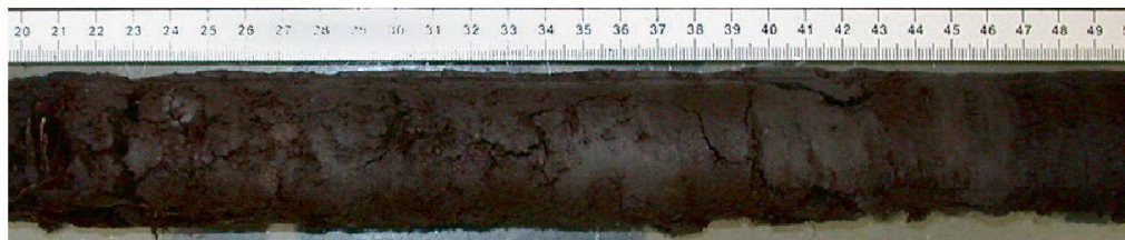
Abb. 4: Überblick über einen 2011 entnommenen Bohrkern (20 bis 50 cm Tiefe) aus dem Schattgaden-Moor bei der Alp Hinter Silberer (Muotathal). Man beachte den stratigraphischen Wechsel von Torf zu siltig-lehmigen Sedimenten bei 46.5 cm Tiefe.
