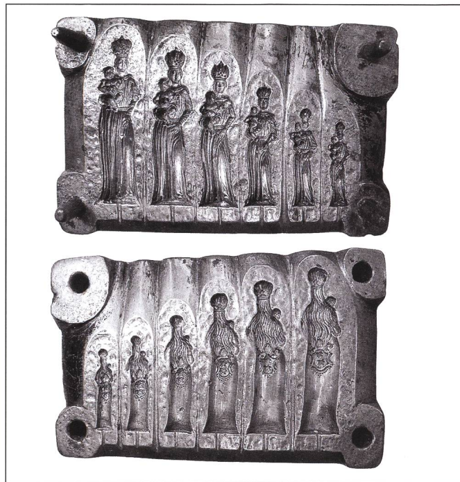
Abb. 9: Diese Pressform aus der Kunstsammlung des Klosters Einsiedeln ist aus Gusseisen gefertigt.
