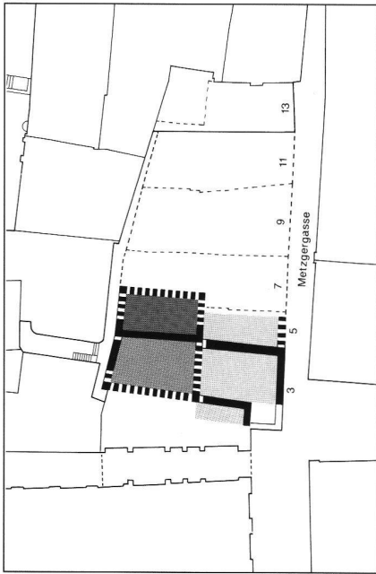
Abb. 2: Metzgergasse 3, «Tanzforst». Grundriss mit der Lage und Abfolge der beobachteten Steinbauten und der 1933 abgebrochenen Altkörper, vgl. Abb. 12.
