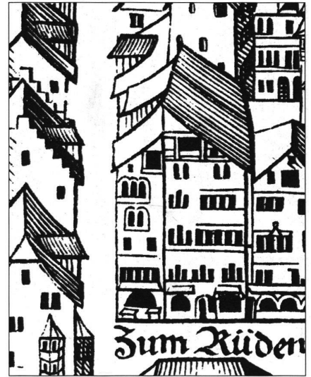
11: Murrvedute: «Henne» (Rüdenplatz 3). Die reich befensterte Fassade des schmalbrüstigen Hauses weist im 3. Obergeschoss eine Rundbogenbifore und im darüberliegenden, obersten Wohn-geschoss, gar eine Trifore auf.
